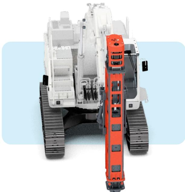
Сваебойные гидравлические молоты MOVAX ударного типа предназначены для забивки несущих свай, а также используются в качестве вспомогательного оборудования для вибропогружателей.
