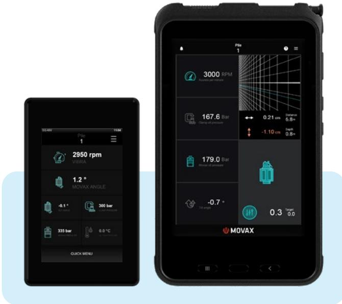
Для выполнения работ по стабилизации грунтов задействуются система управления работой MOVAX mControl+ и система сбора/анализа информации MOVAX mLogbook, основные блоки которых взаимосвязаны друг с другом и соединены шиной CAN. Кроме того, в работе используется система управления питателем высокого давления ALLU, а также программное обеспечение для графического представления полученных данных как в виде таблиц, так и в трехмерном изображении.
